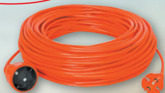
Przedłużacz jednofazowy 2p; 10A; 2500W; przewód OMY 2x1; 10M; pomarańcz; 16A; 4000W; z przewodem H05VV 2x1,5mm dł. 15m, 20m, 25m, 30m, 40m
