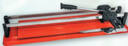
Maszyna ręczna do glazury maks. cięcia 500mm; maks. grubość 16mm; podwójna prowadnica
