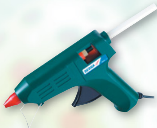
Pistolet do kleju na gorąco 40/80W szer. wkł. klejowych 11,2mm; czas rozgrzewania 2-3min; wyd.12-16g/min
