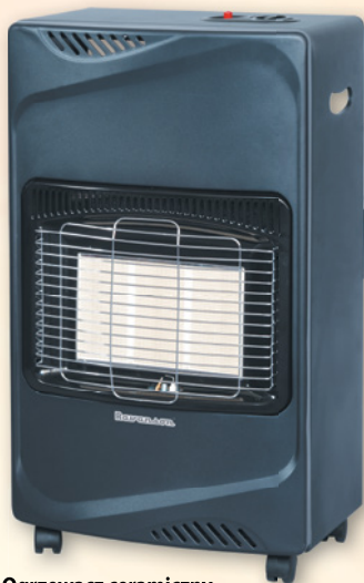
Ogrzewacz ceramiczny LD-168N Ravanson Analizator wypływu CO, odcinający dopływ gazu w przypadku nadmiaru CO 2 w powietrzu zabezpieczenie termoelektryczne; które odcina dopływ gazu w przypadku przerwania procesu spalania; zapalarka piezoelektryczna; kółka i uchwyty do przenoszenia; zużycie gazu: moc max : 4,1 kW zużycie gazu: 299 g/h; rodzaj gazu: G30 (LPG); nominalne ciśnienie gazu: 37 mbar. wymiary produktu: 420x255x730mm.
